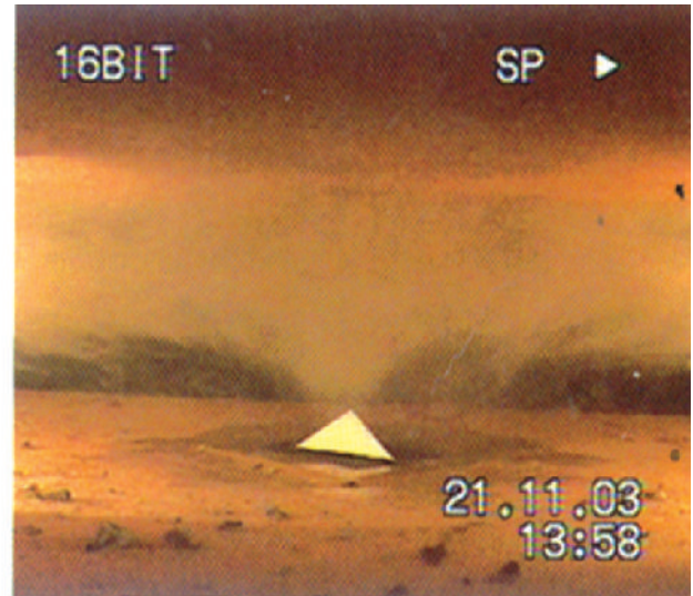
სურ. (Fig.) 77 ლაბორატორიულ პირობებში ხელოვნურად გამოწვეული ტორნადოს ტიპის ჰაერის მოძრაობა. Air motion of tornado type artificially generated in laboratory conditions.
